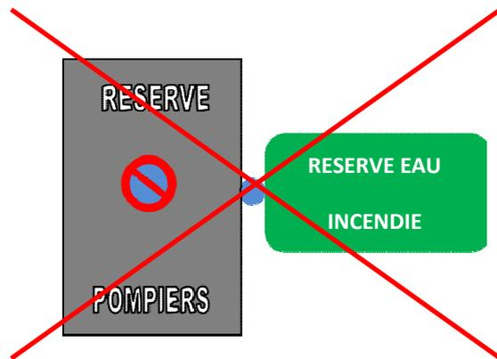
**A PROSCRIRE.** Emplacement non judicieux. Dans ce cas, l'équipement hydraulique n'est pas utilisable en raison de la rigidité des tuyaux d'aspiration ! Il y a lieu soit de déplacer l'équipement hydraulique, soit de déplacer la plate forme d'aspiration.
