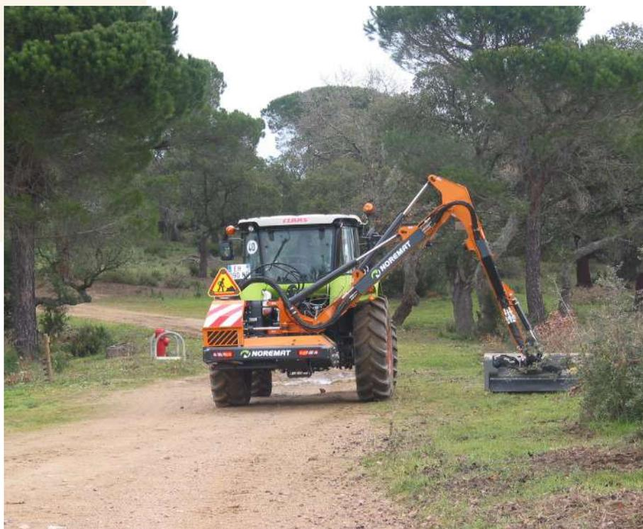
Travaux d'épaveuse sur une piste DFCI
